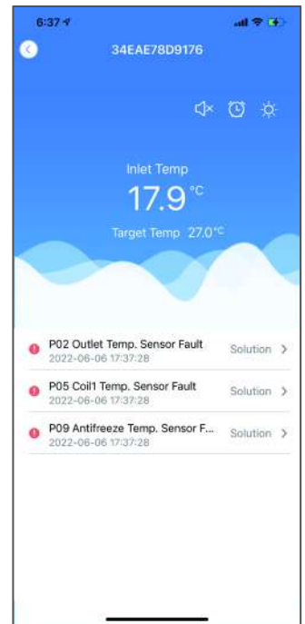
Fig. 19: Registros de fallas
