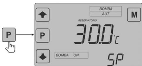
**SP** Programar la temperatura deseada para su piscina, cuando el sensor alcance el valor establecido la bomba se apagará automáticamente.
