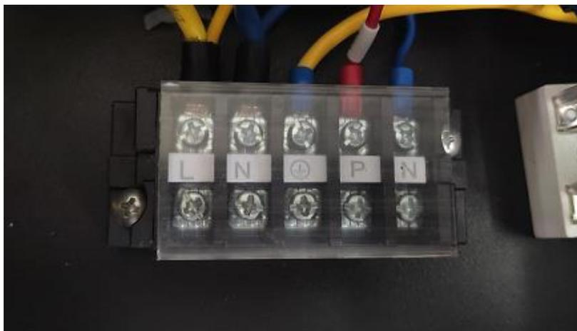
**Nota:** En el caso de los modelos trifásicos, el intercambio de dos fases puede hacer que los motores eléctricos funcionen en la dirección inversa, lo que puede provocar daños. Por esta razón, la unidad tiene un dispositivo de protección incorporado que interrumpe el circuito si la conexión no es correcta. Si se enciende el LED rojo ubicado sobre el dispositivo de seguridad, debe intercambiar las conexiones de dos de los cables de fase.
